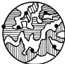
Рис. 6.10. Типичное строение гранулы гетерогенного катализатора. Заштрихованные области обозначают решетку твердого тела, светлые области — систему пор, черные точки — активные центры катализатора
