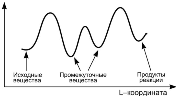
Рис. 1.1. Профиль потенциальной энергии для химической реакции
